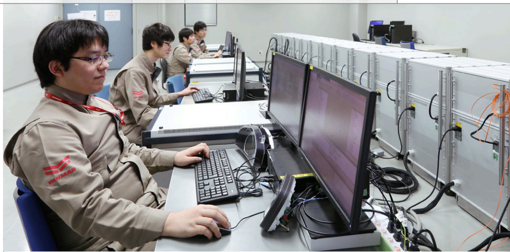
標準化されたプロセッサ/電源ラックおよびマスター I/O ラックのセット
