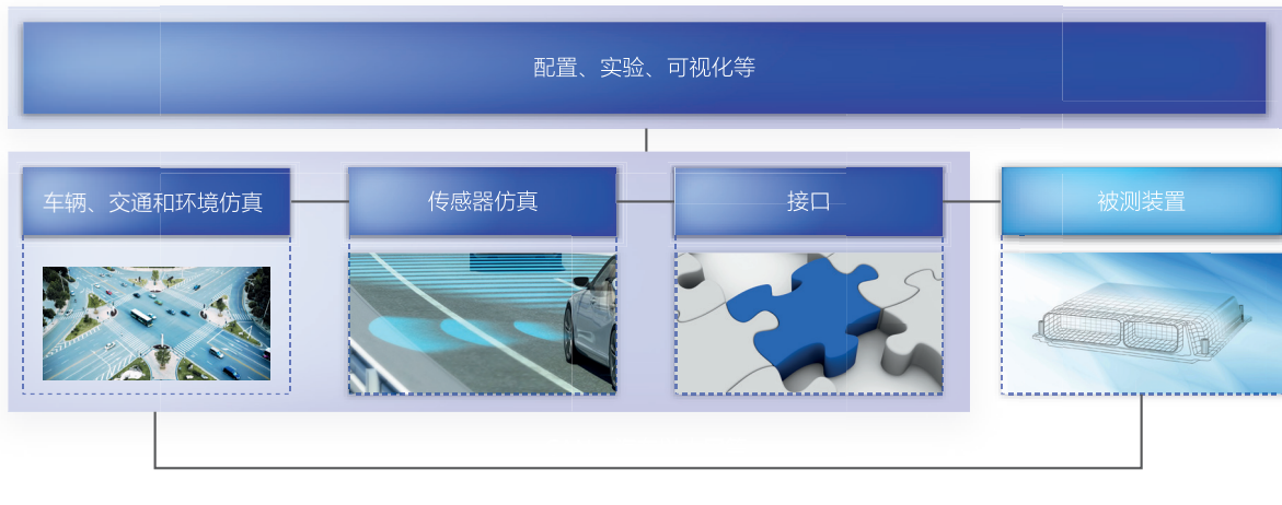
图 1：ADAS 和 AD 功能仿真环境的基础结构。借助标准 PC 技术 (MIL/SIL) 或通过添加实际控制单元 (HIL)，可以进行纯虚拟仿真。
