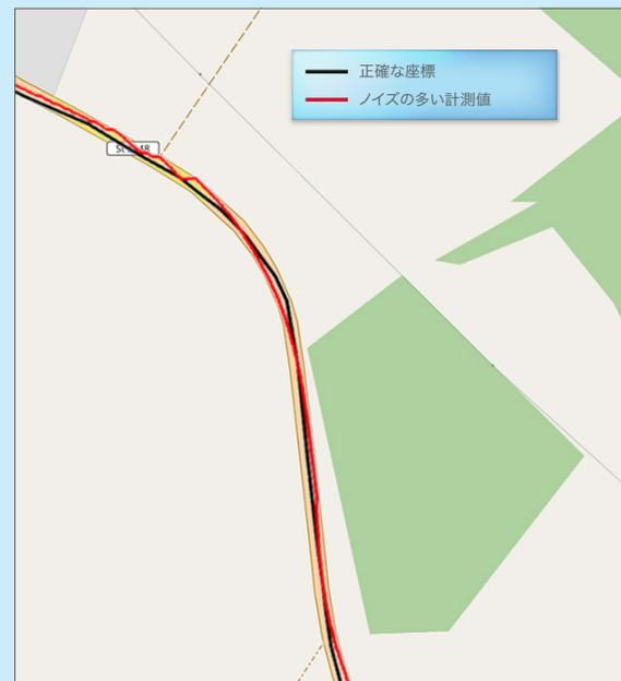
左：テストコースの正確な座標（青）は、マップマッチングによって計測されるノイズの多い値（オレンジ）から特定されます。
