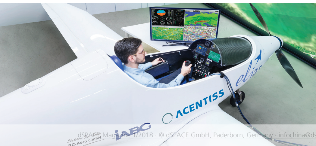
图 1：飞机在环仿真用于对地面飞行控制算法进行全面测试。
