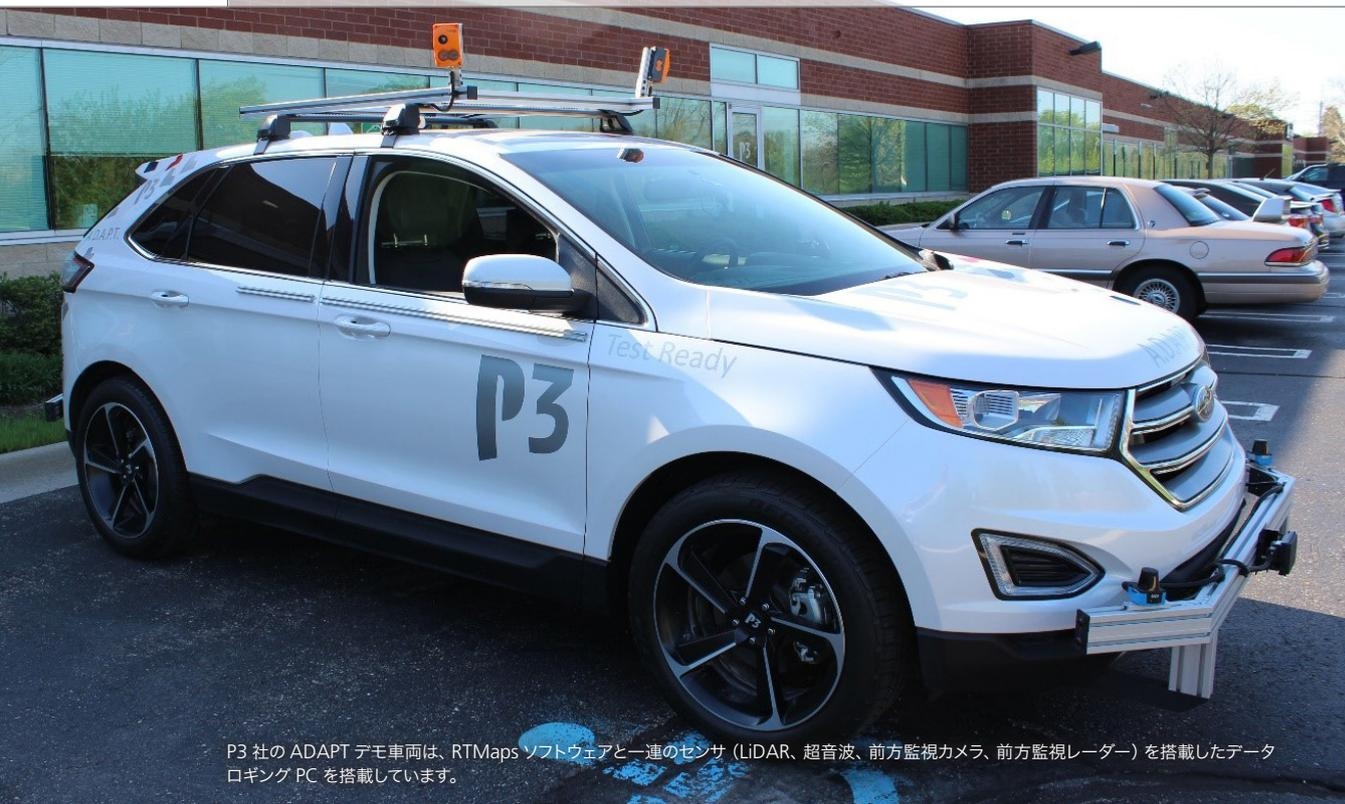
P3 社の ADAPT デモ車両は、RTMaps ソフトウェアと一連のセンサ (LiDAR、超音波、前方監視カメラ、前方監視レーダー) を搭載したデータロギング PC を搭載しています。
