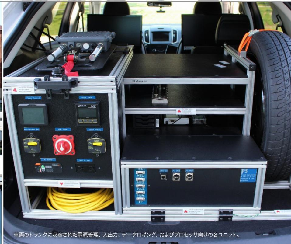
車両のトランクに収容された電源管理、入出力、データロギング、およびプロセッサ向けの各ユニット。
