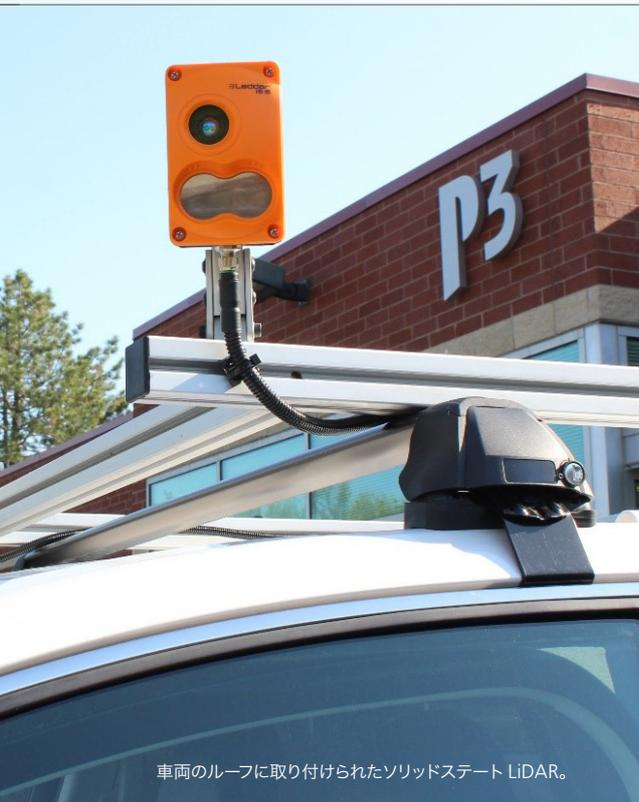
車両のルーフに取り付けられたソリッドステート LiDAR。
