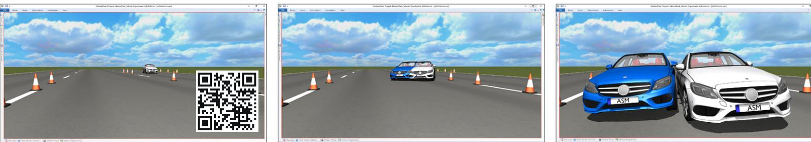
ASM ツールスイートでシミュレートしたステップステアリング操作において、2つの異なるシャシタイプの車両の挙動を重ね合わせた表示。次のサイトで運転操作の動画をご覧ください： [www.dspace.jp/go/dMag\\_20181\\_steer](http://www.dspace.jp/go/dMag_20181_steer)
