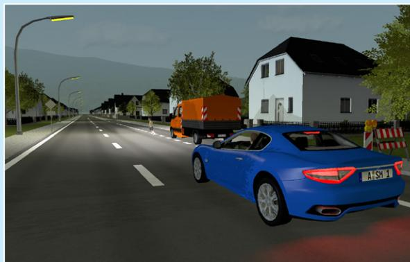
dSPACE MotionDesk では、テストシナリオの照明条件を個別に変更したり、対象となる使用事例に合わせて正確に調整したりすることができます。そのため、MotionDesk の 3D アニメーションを先進運転支援システムや自動運転の分野で使用し、アダプティブフロントライティングシステム (AFS) などのさまざまなアプリケーションを適切に開発することが可能です。
