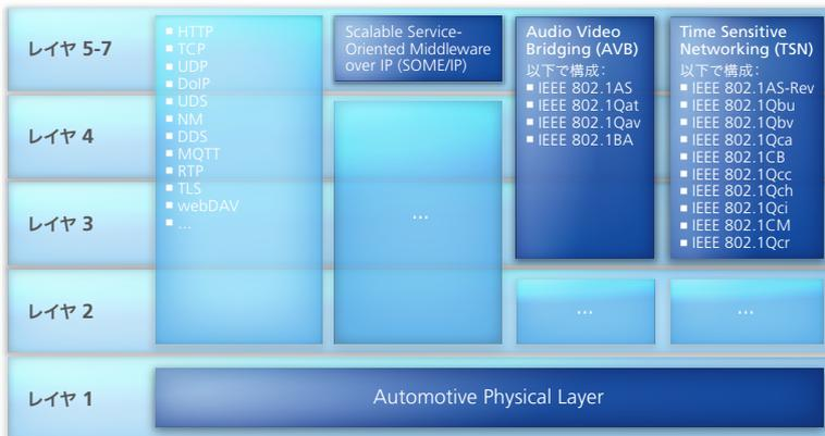
豊富な可能性：車載 Ethernet では、物理層の上に複数のソフトウェア層が存在します。これらを使用して、SOME/IP、AVB、TSN などのプロトコルをアプリケーションごとに組み合わせることができます。
