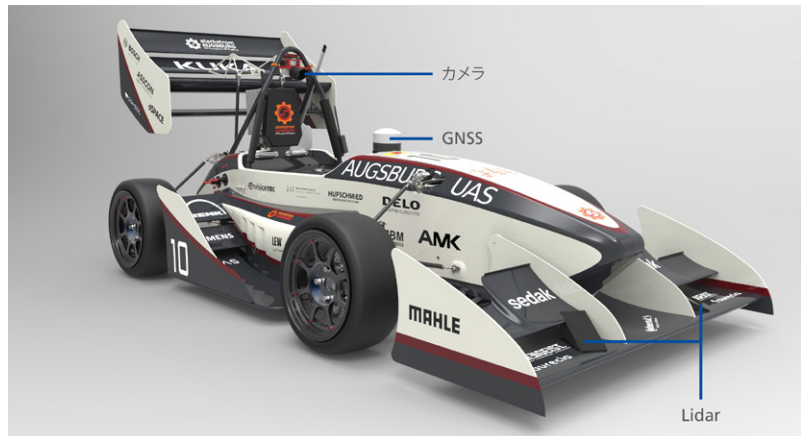
アウクスブルク応用科学大学が開発した自動運転レーシングカーは、全地球的航法衛星システム (GNSS) を搭載しており、1台のカメラと2個のLiDARセンサを使用して環境情報を取得しています。
