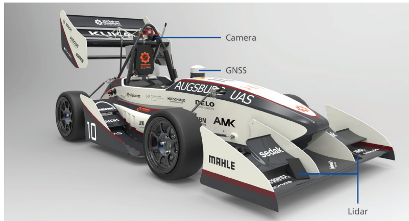
奥格斯堡应用科技大学的自动驾驶赛车配备了全球导航卫星系统 (GNSS)，并通过一个摄像头和两个激光雷达传感器来捕捉其周围环境。
