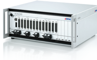
紧凑的 SCALEXIO LabBox 最多可以搭载 18 块板卡。
