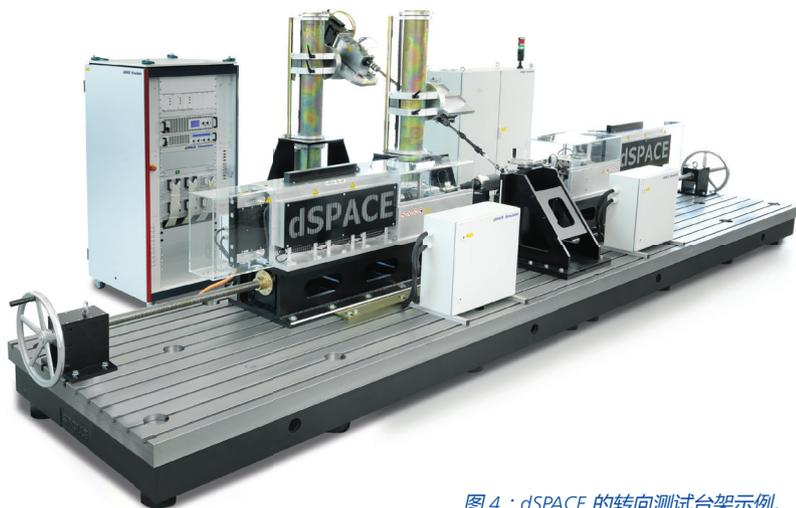
图 4 : dSPACE 的转向测试台架示例。
