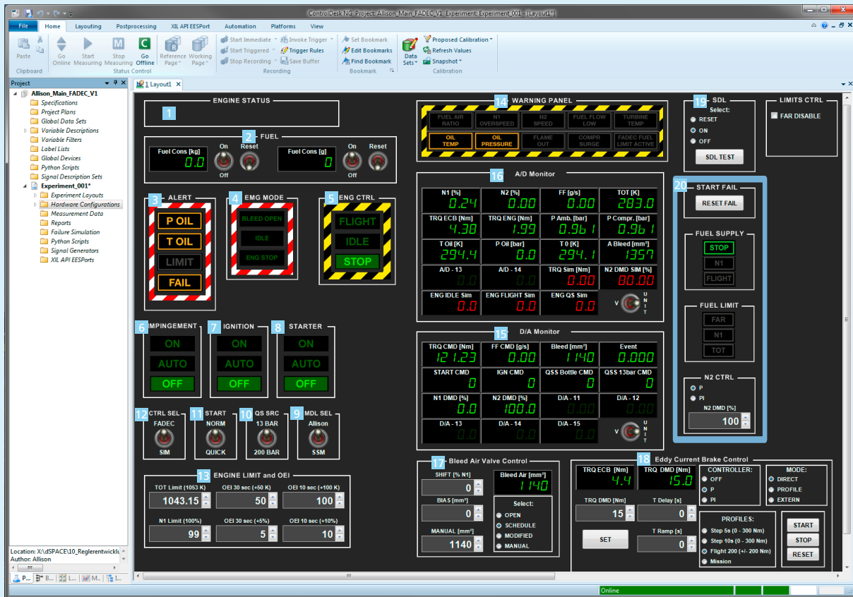
Abbildung 4: Die umfangreichen Einstell- und Anzeigeparameter für die Triebwerkstests wurden mit der dSPACE Experimentier-Software ControlDesk in einer grafischen Bedienoberfläche übersichtlich dargestellt.
