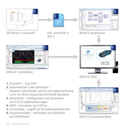
Typischer Prozess für die V-ECU-Generierung mit den Tula-DSF-Funktionen. Diese werden anschließend zu Testzwecken auf VEOS simuliert.
