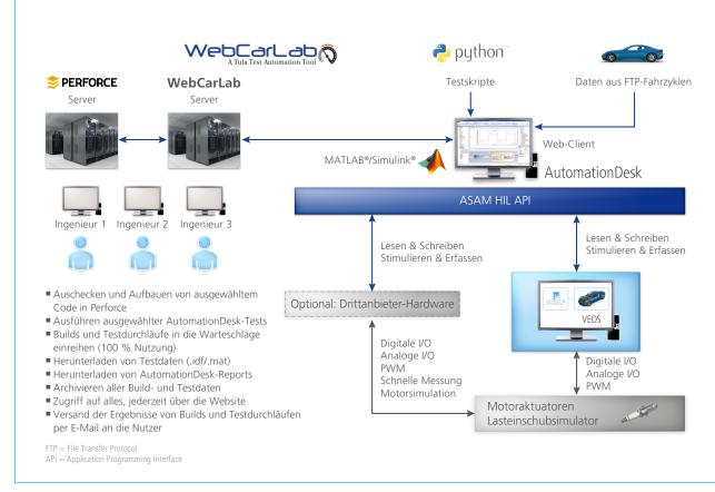
In der neuen Infrastruktur zum Absichern und Verifizieren werden der komplette Code und alle Testskripte über dSPACE AutomationDesk organisiert und mit Hilfe der PC-basierten Simulationsplattform dSPACE VEOS ausgeführt.
