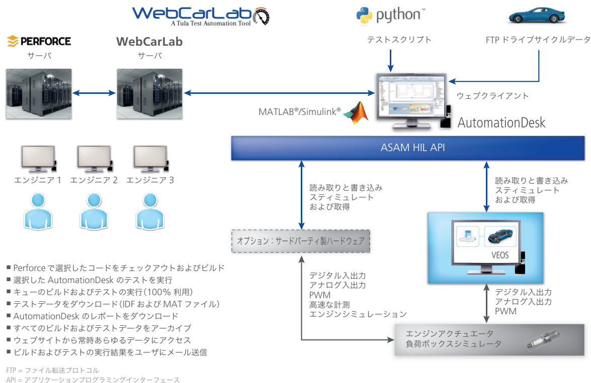
図 1：Tula 社の新しい妥当性確認および検証インフラストラクチャでは、dSPACE AutomationDesk によりあらゆるコードおよびテストスクリプトを体系化し、PC ベースのシミュレーションプラットフォームである dSPACE VEOS によりそれらを実行しています。
