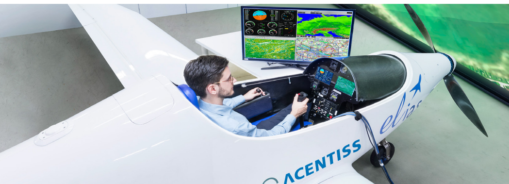
Abbildung 1: Mit Hilfe einer „Aircraft-in-the-Loop“-Simulation werden die Flugregelalgorithmen bereits am Boden umfassend getestet.
