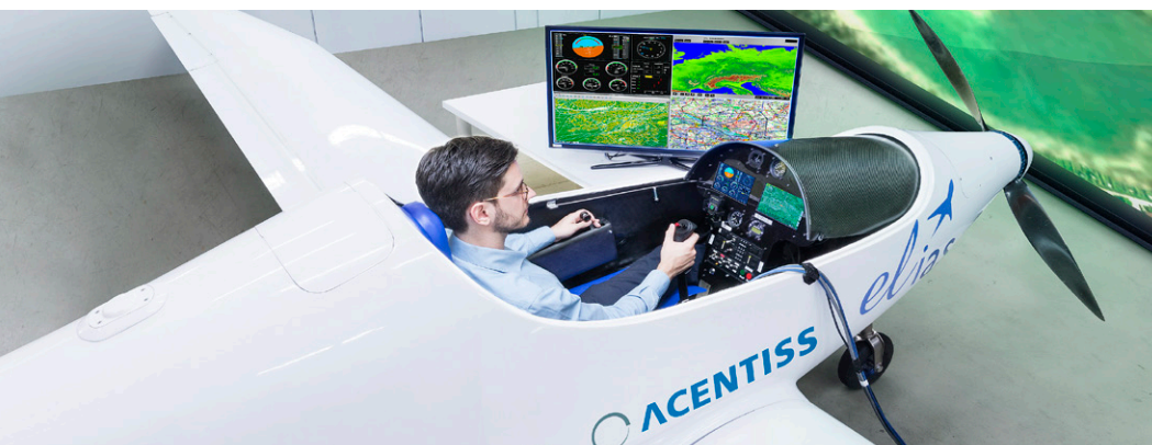
図 1 : 地上での飛行制御アルゴリズムの総合的なテストには、ACIL (Aircraft-in-the-Loop) シミュレーションが使用されています。
