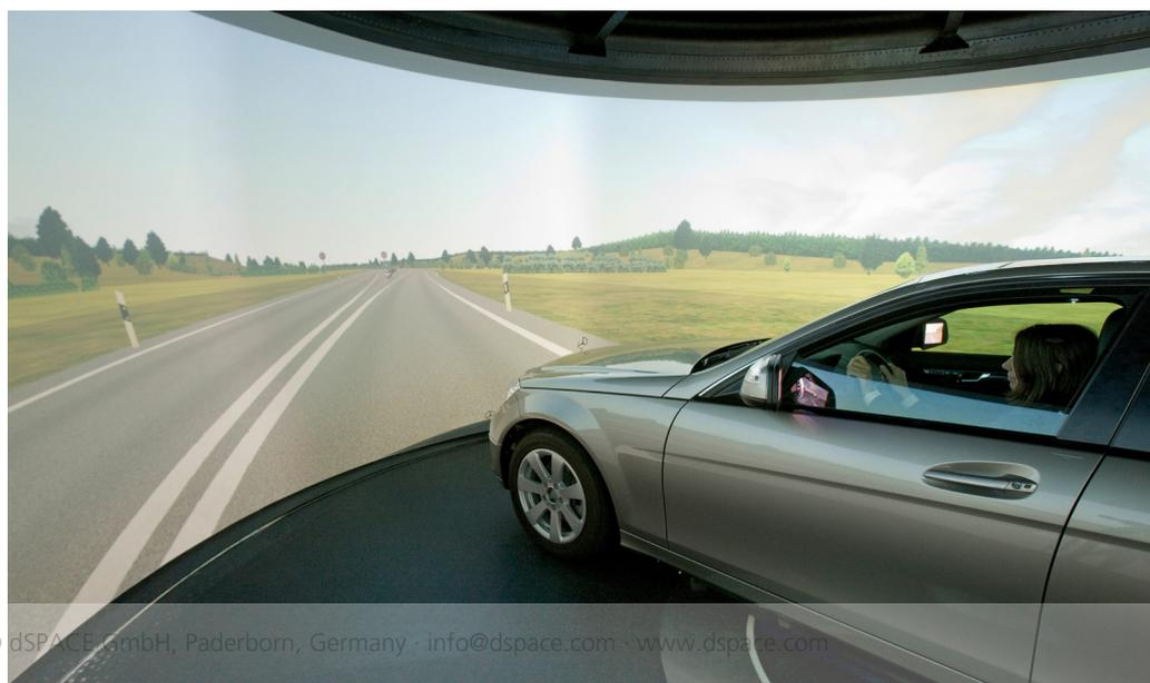
der Lage sein, das Fahrwerk so genau wie nötig und so einfach wie möglich zu modellieren. Die meist eingesetzten Fahrzeugmodelle verzichten auf Strukturbauteile und Lagerung, stattdessen werden die Funktionen durch Kennlinien und Kennfelder beschrieben. Dadurch können die Modelle sowohl ausreichend Genauigkeit bieten als auch echtzeitfähig bleiben.
