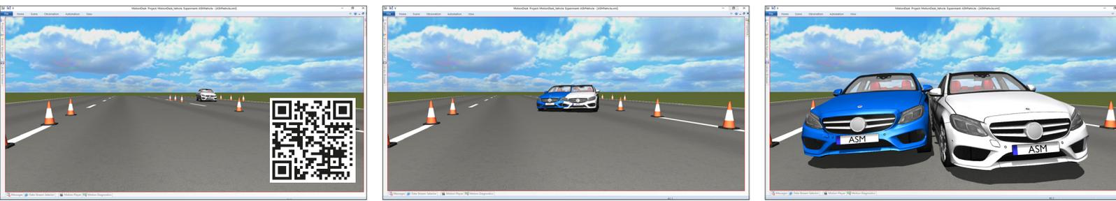
Überlagerte Darstellung des Fahrzeugverhaltens bei unterschiedlich ausgelegten Fahrwerken in einem Lenkwinkelsprung-Manöver, simuliert mit der Toolsuite ASM. Ein Video des Fahrmanövers sehen Sie unter: [www.dspace.com/goldMag\\_20181\\_steer](http://www.dspace.com/goldMag_20181_steer)
