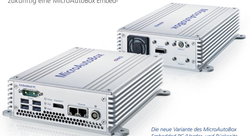
Die neue Variante des MicroAutoBox Embedded PC (Vorder- und Rückseite dargestellt) kann auch als Stand-alone-System ohne reguläre MicroAutoBox eingesetzt werden.
