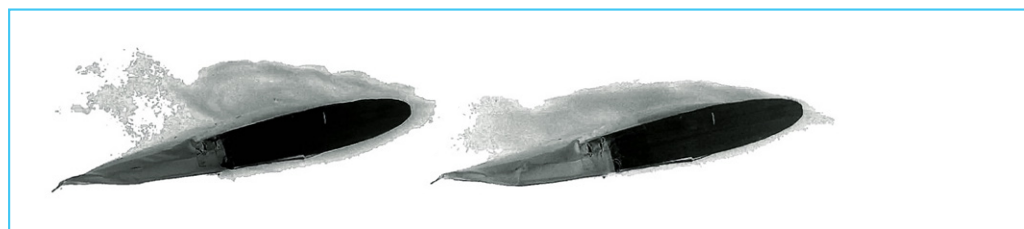
図4：気流をビジュアル表示することにより、ストールの状況に合わせて翼の形状を調整した場合の効果を確認できます。左：調整が行われなため、強い旋風が形成されます。右：翼の調整により、旋風の形成がほぼ完全に抑制されます。
