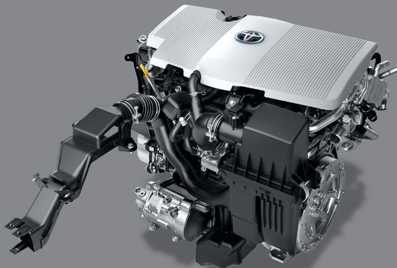
丰田普锐斯内燃机。它与电机和动力分配装置直接连接。
