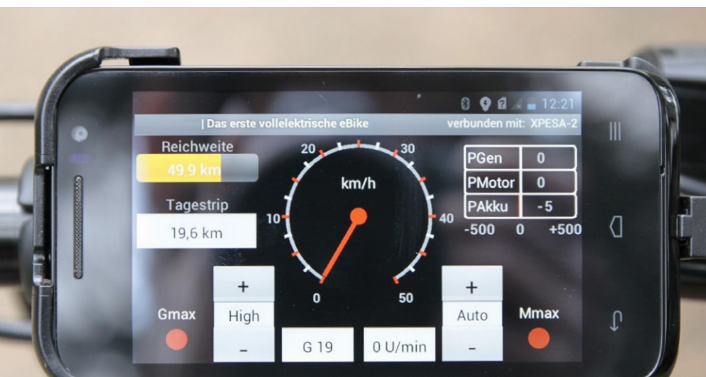
図2：Bluetooth を介して接続したスマートフォンのユーザインターフェース
