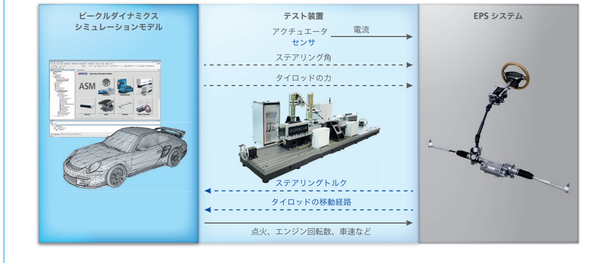
図3：テスト装置のコンポーネント、信号、アクチュエータ、およびセンサ
