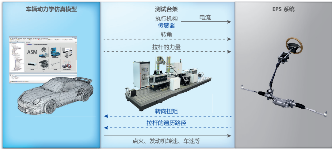
图 3 : 测试台架的组件、信号、执行机构和传感器。
