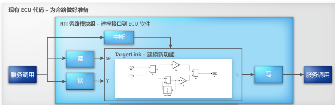
图 3：用于开发新功能的 TargetLink 和 RTI 旁路模块。
