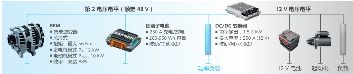
图 3 : Bosch 48 V 带传动起动发电机的布局。
