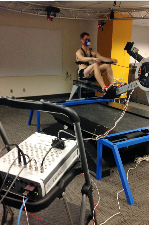
图 3：在试验期间，dSPACE MicroLabBox（左图）以 1 kHz 采样率收集 16 通道肌电图 (EMG) 数据和器械机械数据。一个单独系统使用可视标记（亮点）和代谢数据收集运动数据。来自所有系统的数据都通过离线后处理同步。
