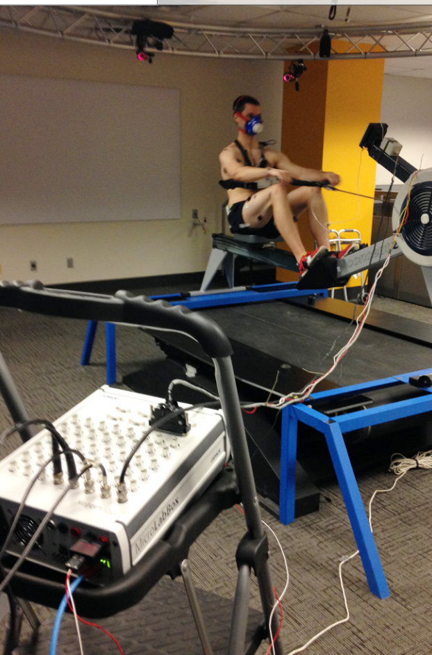
図3：試験中は dSPACE MicroLabBox (左図) により、16 チャンネルの筋電図検査 (EMG) データとマシンの機械的データが 1 kHz のサンプリングレートで収集されます。別のシステムでは、視認可能なマーカー (光の点) と代謝データを使用して運動データを収集します。すべてのシステムから取得したデータは、オフラインの後処理によって同期化されます。
