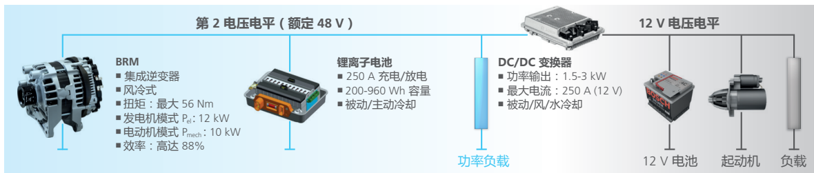
图 3 : Bosch 48 V 带传动起动发电机的布局。
