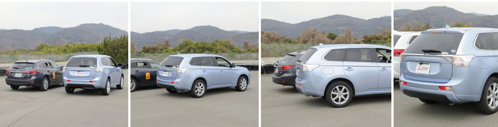
スマートフォンなどの外部デバイスを使用して自動駐車機能を実行
