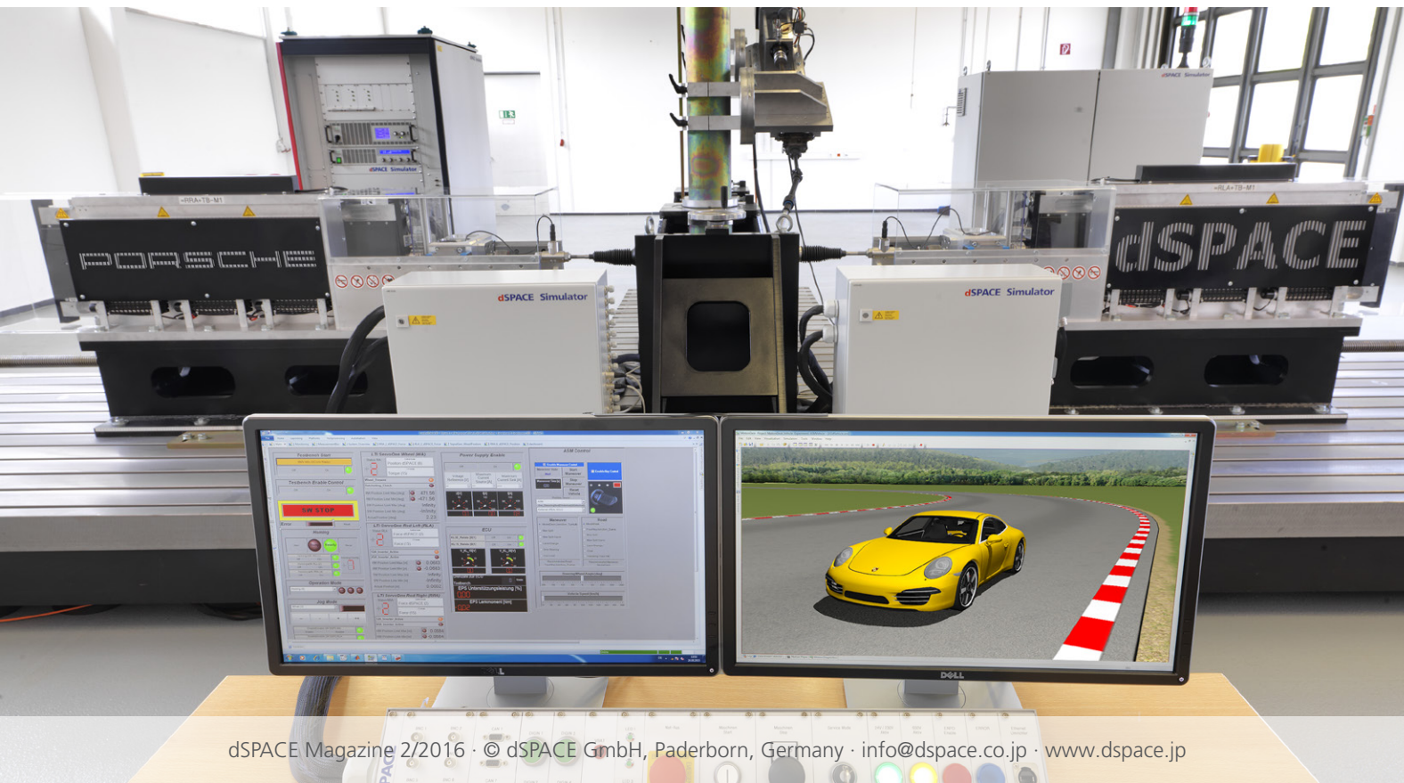
図 4：テスト制御用の ControlDesk (左) と運転操作をビジュアル表示する MotionDesk (右) を搭載したオペレータ用ワークステーションを含むメカトロニクステスト装置
