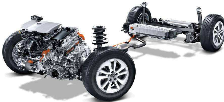
Aufbau des elektrifizierten Antriebsstrangs des Toyota Prius 4.
