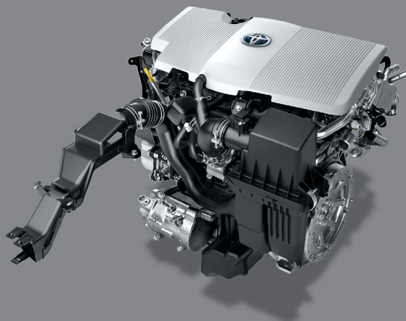
トヨタプリウスの内燃エンジン。モーターおよびパワースプリットデバイスと直接接続されています。
