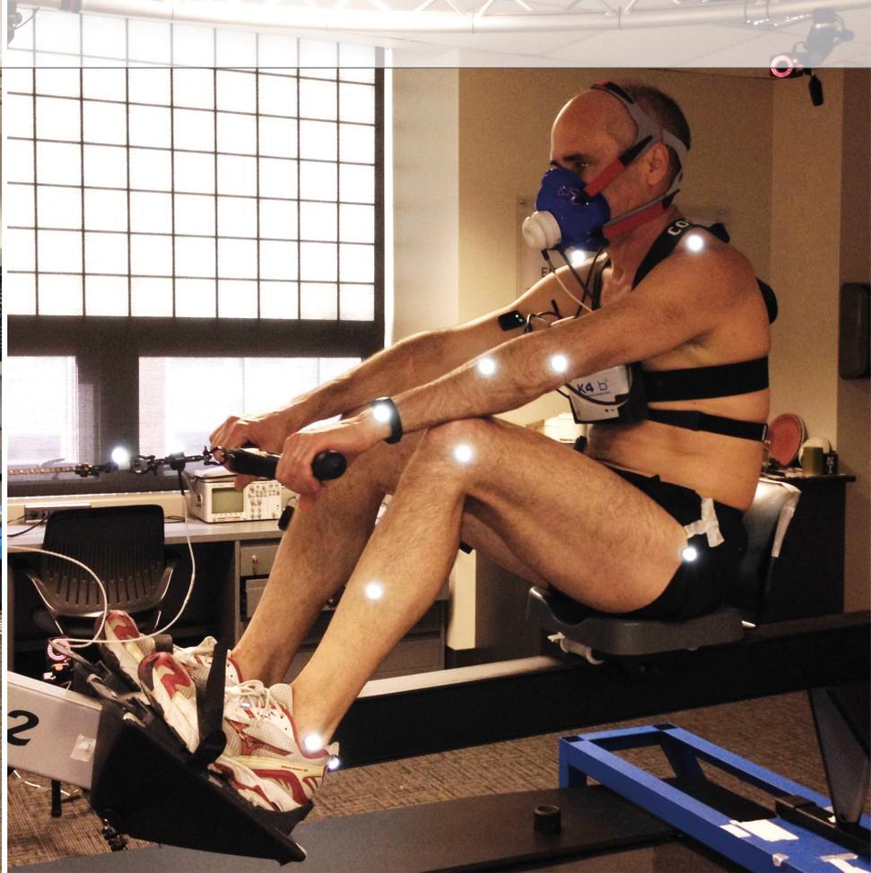
Abbildung 3: Während eines Versuchs erfasst die dSPACE MicroLabBox (linkes Bild) die Daten der Elektromyografie von 16 Kanälen sowie die mechanischen Daten des Sportgeräts mit einer Abtastrate von 1 kHz. Ein weiteres System sammelt Bewegungsdaten mithilfe visueller Marker (helle Punkte) und Werte über den Metabolismus. Die Daten aller Systeme werden offline nachbearbeitet und synchronisiert.
