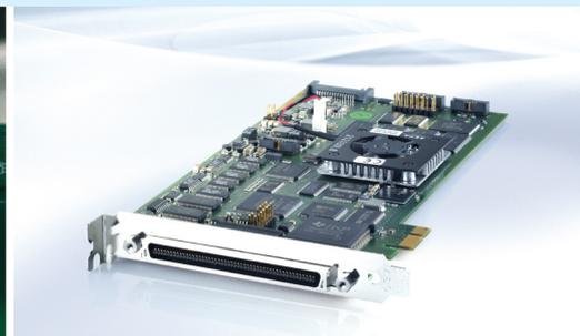
*Die Berechnung der adaptiven Algorithmen erfolgt auf dem DS1104 R&D Controller Board von dSPACE.*
