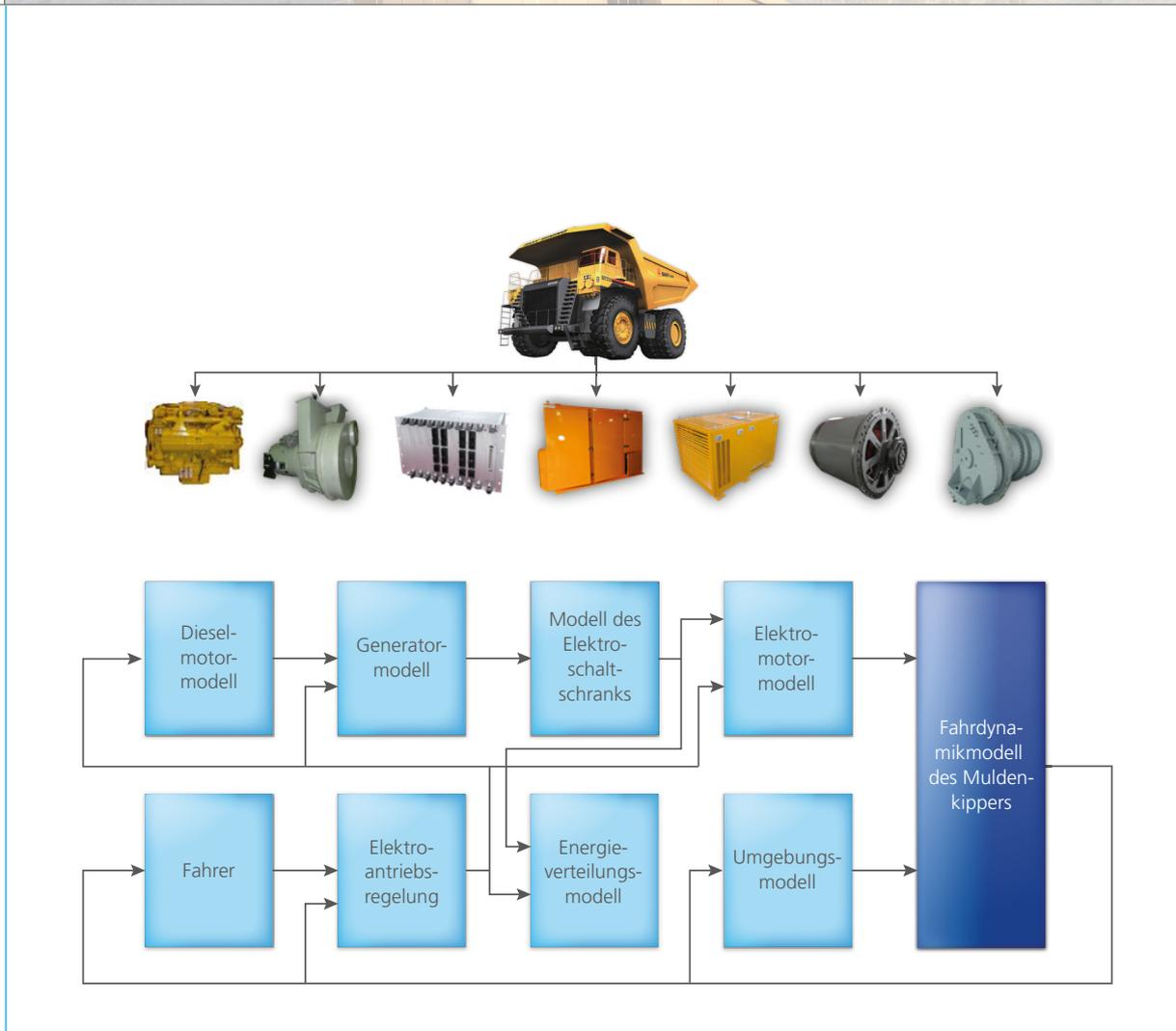
*Breites Spektrum an Modellparametern: Vom Dieselmotor und den Komponenten der elektrischen Antriebe über den Fahrer bis hin zur Umgebung fließen zahlreiche Faktoren in das Fahrdynamikmodell des Muldenkippers ein.*
