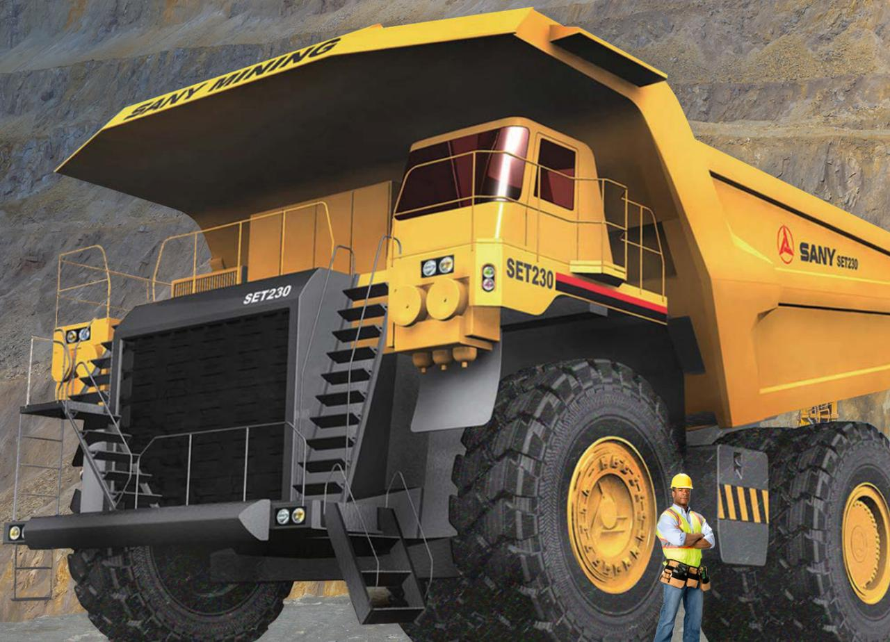
Mit dem Muldenkipper SET230 des chinesischen SANY-Konzerns lassen sich in einer Fuhre bis zu 230 Tonnen Nutzlast bewegen. Sein diesel-elektrischer Antrieb und ein dSPACE HIL-Simulator sorgen dabei für größtmögliche Effizienz: der eine im Schwerlasteinsatz, der andere in der Entwicklung und Validierung der aufwendigen Antriebsregelung.
