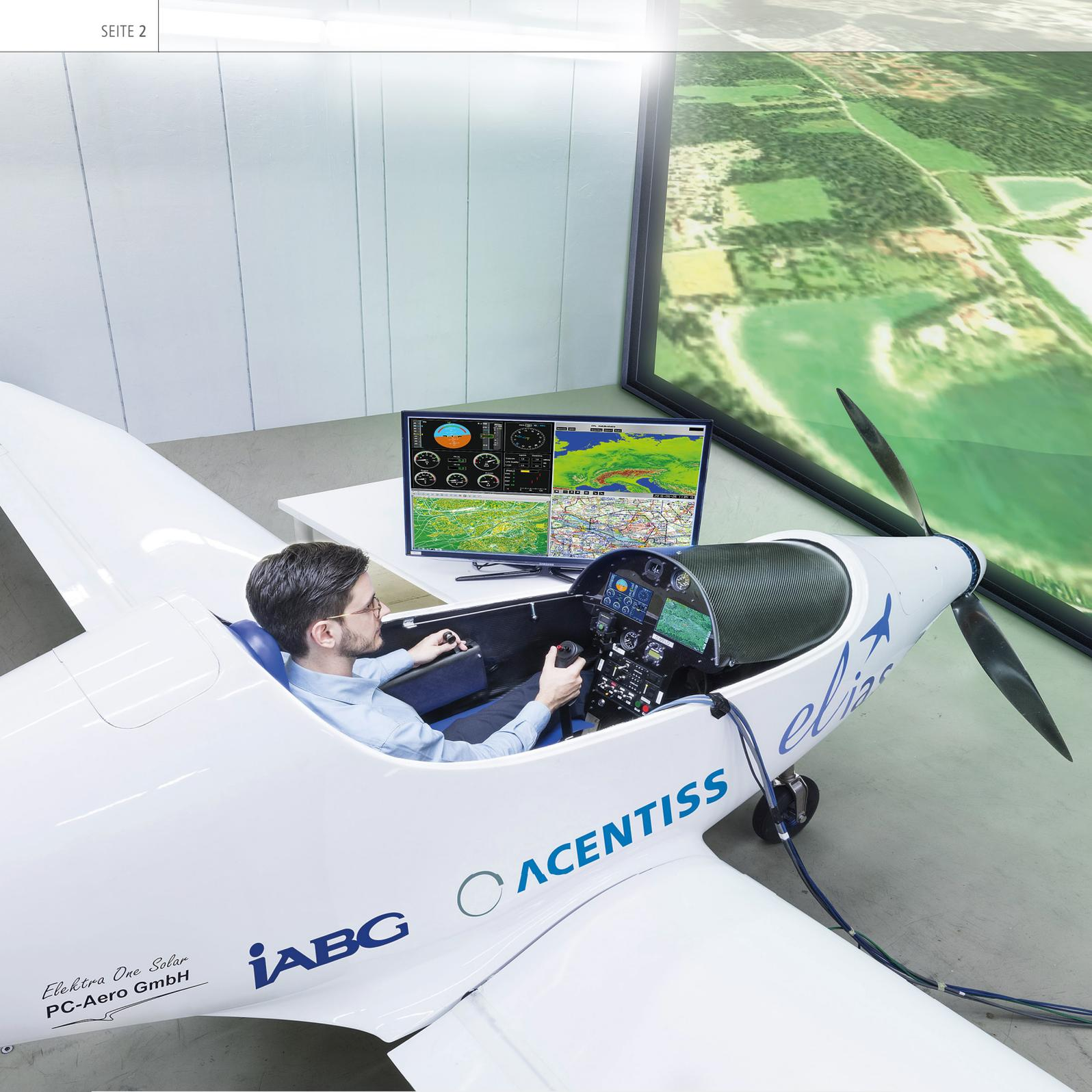
„Zur Vorbereitung der Flugversuche wird das vollelektrische Flugzeug ELIAS ausführlich in der ‚Aircraft-in-the-Loop‘-Simulation bei unserem Mutterkonzern IABG getestet. Dabei verifizieren wir nicht nur den automatischen Flug, sondern auch das Umschalten von Manuell auf Automatik im Flug. Die MicroAutoBox von dSPACE ist dabei als Flugführungsrechner mit an Bord.“
