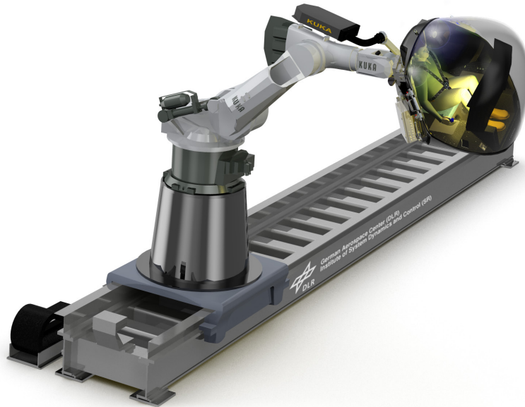
图 3：为增加操作空间，将一个线性轴用于 DLR 机器人运动仿真器 (RMS)。
