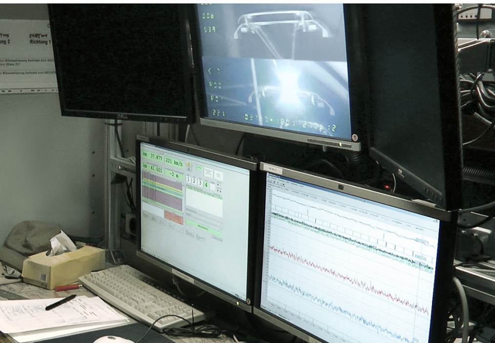
图 5：试车过程可用于演示新型受电弓如何高效地防止产生电弧。
