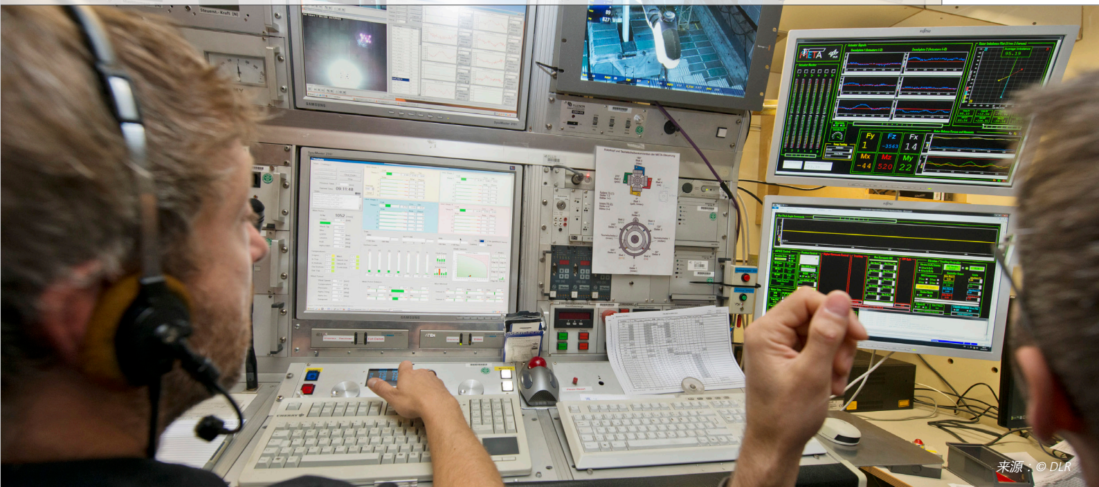
风洞测试中的控制和监视系统，两个 ControlDesk 界面（右侧）。
