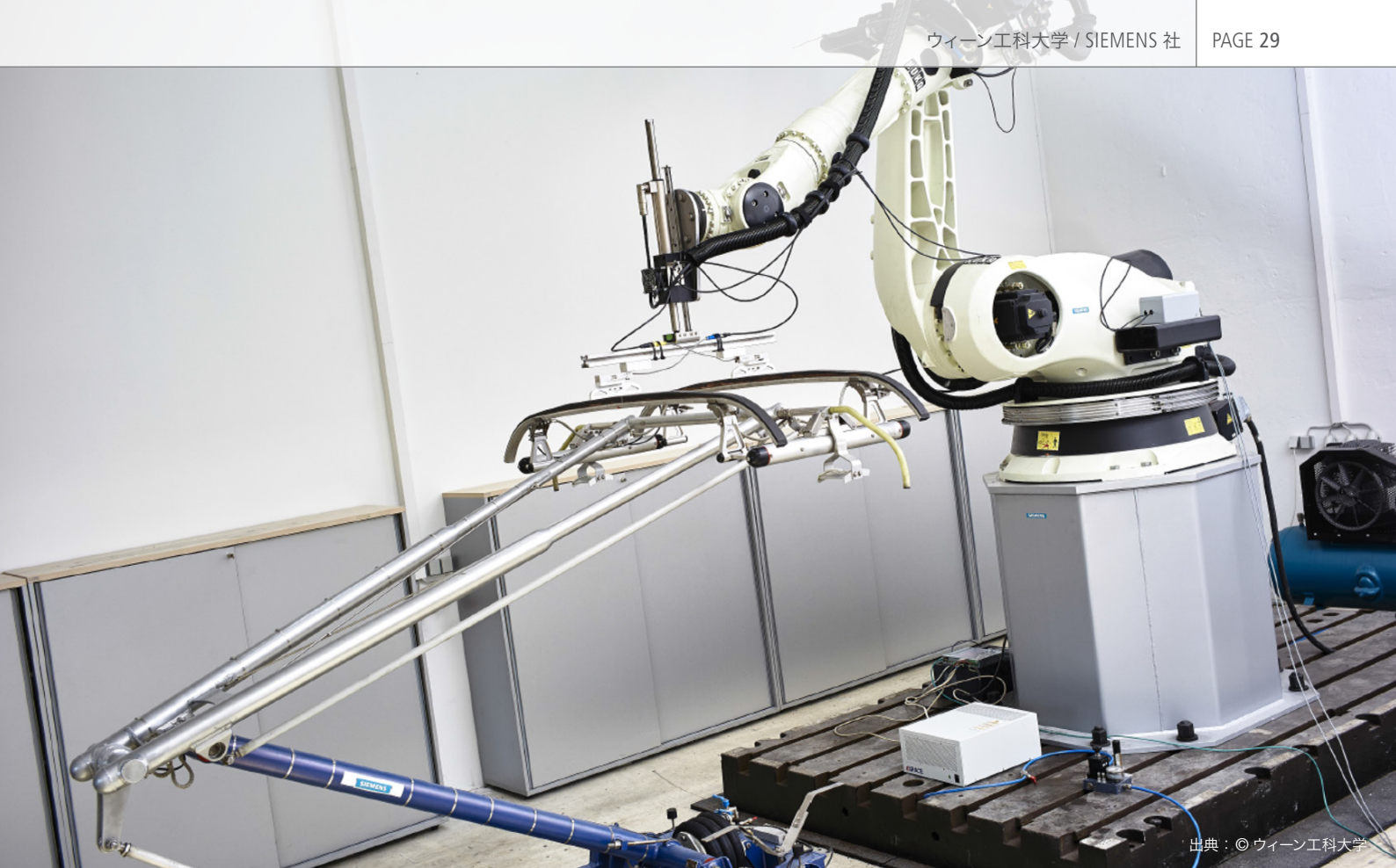
図3：ウィーン工科大学では、パンタグラフのテストに際し、Siemens 社製のテストベンチシステムおよび多数の I/O 拡張機能を搭載した DS1006 Processor Board を組み合わせて使用しています。
