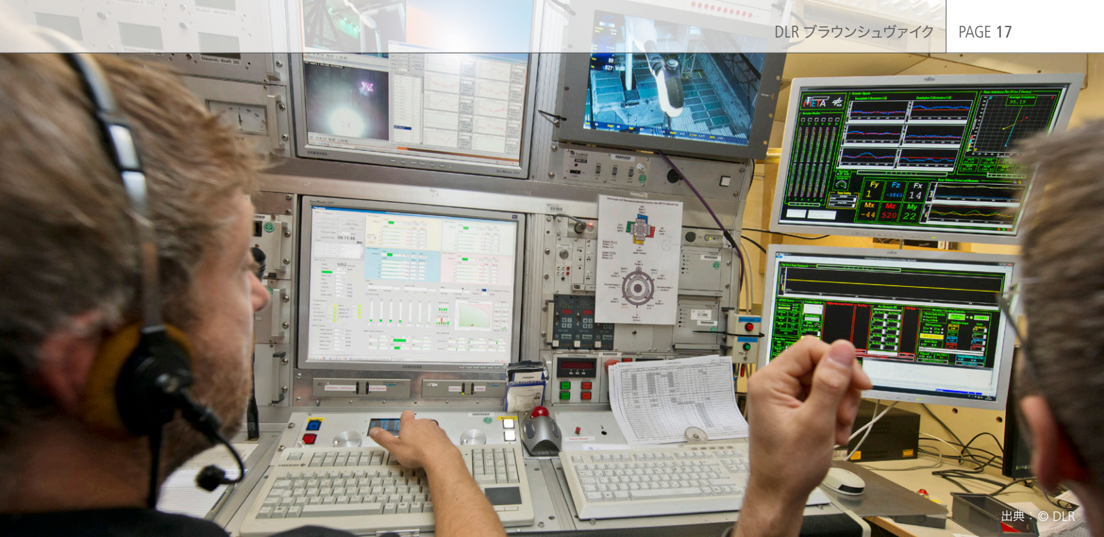
ControlDesk を 2 画面に配備 (右) した風洞テスト用の制御および監視システム
