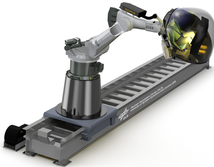
図3：DLR Robotic Motion Simulator (RMS) ではリニア軸が採用されており、操作スペースの拡張が可能になっています。
