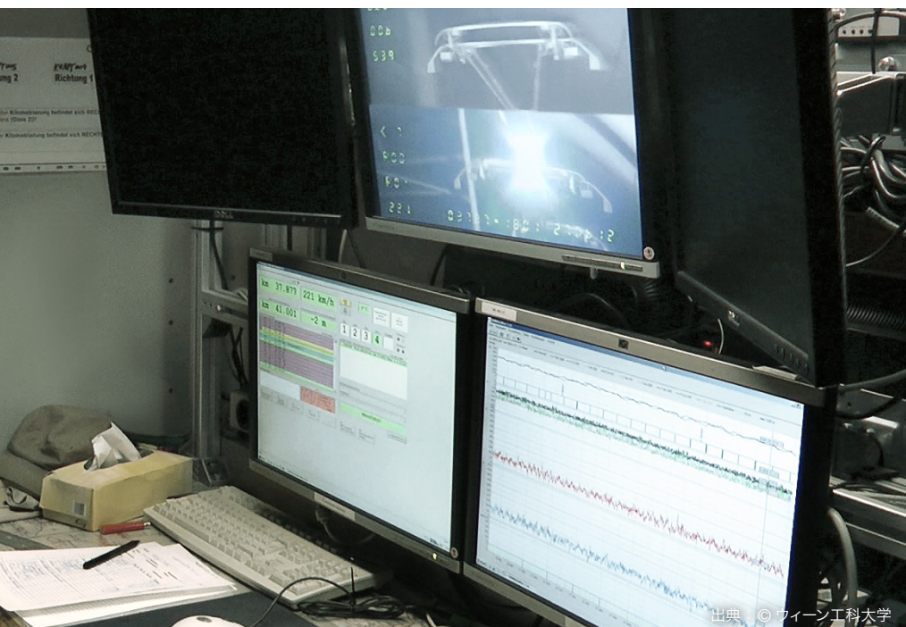
図5：テストドライブを使用して、新型パンタグラフのアーカ放電の防止効果を実証しています。
