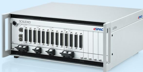
Mit der Desktop-Version und der SCALEXIO Processing Unit lassen sich initiale HIL-Tests schnell und bequem am Schreibtisch durchführen.
