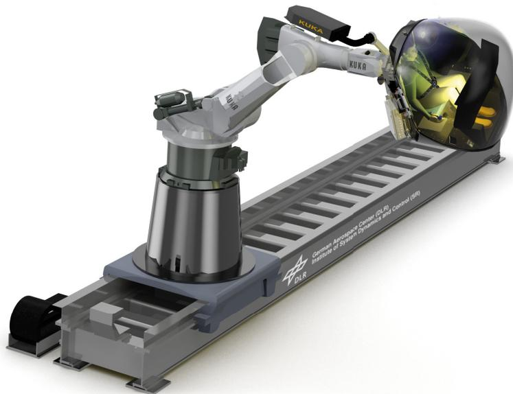
Abbildung 3: Zur Erweiterung des Arbeitsraums wird im DLR Robotic Motion Simulator (RMS) eine Linearachse eingesetzt.
