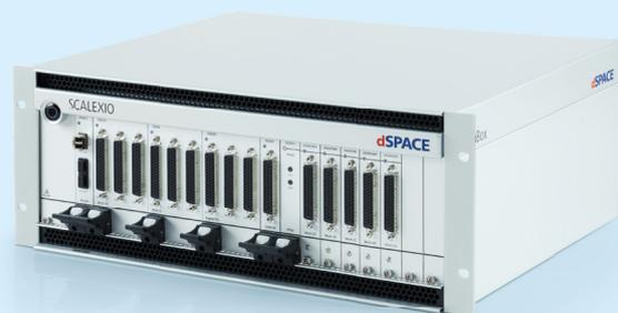
Die Einschubausführung eignet sich für den Einbau in 19-Zoll-Systeme. Dies erleichtert den Einsatz in projekt-spezifischen HIL-Systemen.
