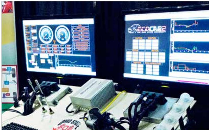
图 2：ControlDesk® Next Generation 既用在 dSPACE HIL 仿真器的测试中，也用在 dSPACE MicroAutoBox II 控制器的应用程序中。
