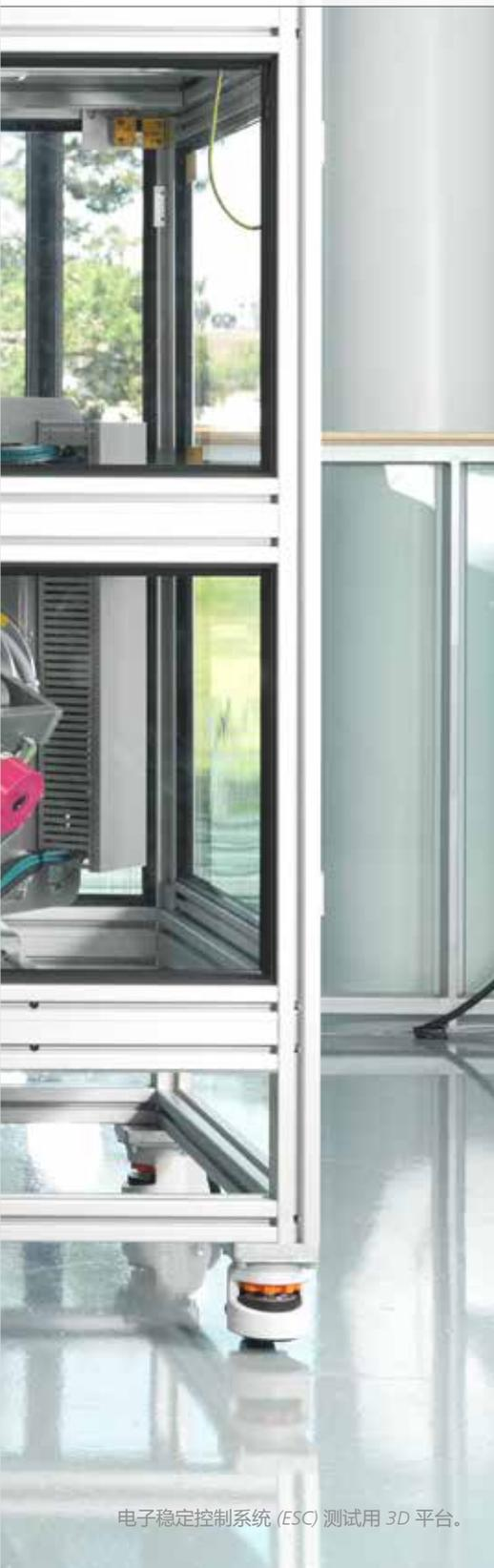
电子稳定控制系统 (ESC) 测试用 3D 平台。
