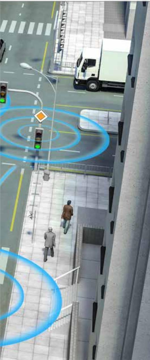
如今的辅助驾驶系统使用雷达和摄像头等环境传感器扫描车辆的行驶环境。但是，如果这些系统的视野在交叉路口被大型建筑或其他车辆等物体遮蔽，则有些环境信息将会被丢失（图 1）。通过引入 V2X 技术，这类限制将成为过去。V2X 技术中的“X”代表车辆行驶环境中的其他对象，不仅包括其他车辆，还包括部分基础设施，例如交通信号灯和道路标志等。V2X 技术又经常被称为 C2X 或 Car2X，这种技术能够通过基于 WLAN 的 Ad-hoc 网络标准 ITS-G5 (IEEE 802.11p) 在所有这些对象之间交互信息。交互的数据包含有车辆的位置、速度、行驶方向或行驶环境中的突发事件（如：交通堵塞、施工现场或湿滑路面等）信息。推广 V2X 技术的目标是提高交通安全性和驾驶舒适性，并且优化交通流。因此该技术是迈向自动驾驶的又一步举措。
