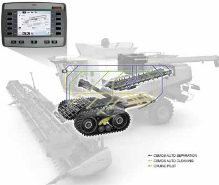
一些负担，以便只需要输入最重要的设置，有些功能可以变为半自动化。新的辅助系统 CEMOS AUTOMATIC（CLAAS 电子化机器优化系统）可以应对挑战并优化粮食收割。CEMOS 可以监视收割过程，调整过程参数，使机器不断适应收割条件。成功的关键是在线建模：辅助系统持续地计算机器和环境模型，分析各个参数，并确定最佳参数集。然后将这些参数传送给机器。
