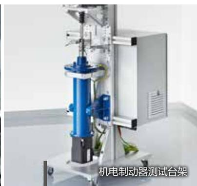
机电制动器测试台架
