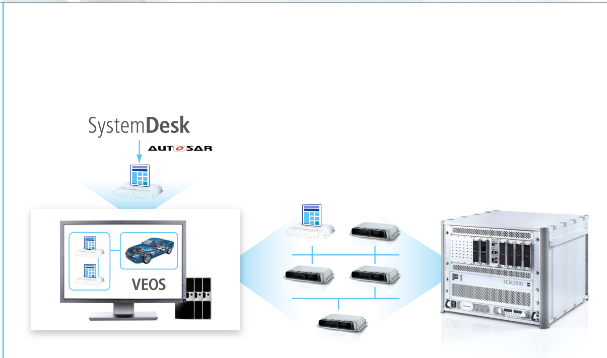
Abbildung 3: Virtuelle Steuergeräte können sowohl mit dSPACE VEOS als auch mit SCALEXIO verwendet werden. Konfiguration und Bedienung erfolgen in beiden Fällen mit derselben Software.
