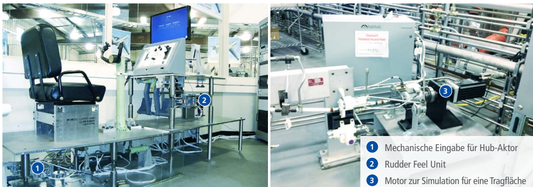
Abbildung 8: Pilotenplatz mit realitätsnahen Steuerungen und Flugsteuerungshardware (links); Hochauftriebsprüfstand für Verkehrsflugzeuge (rechts)
