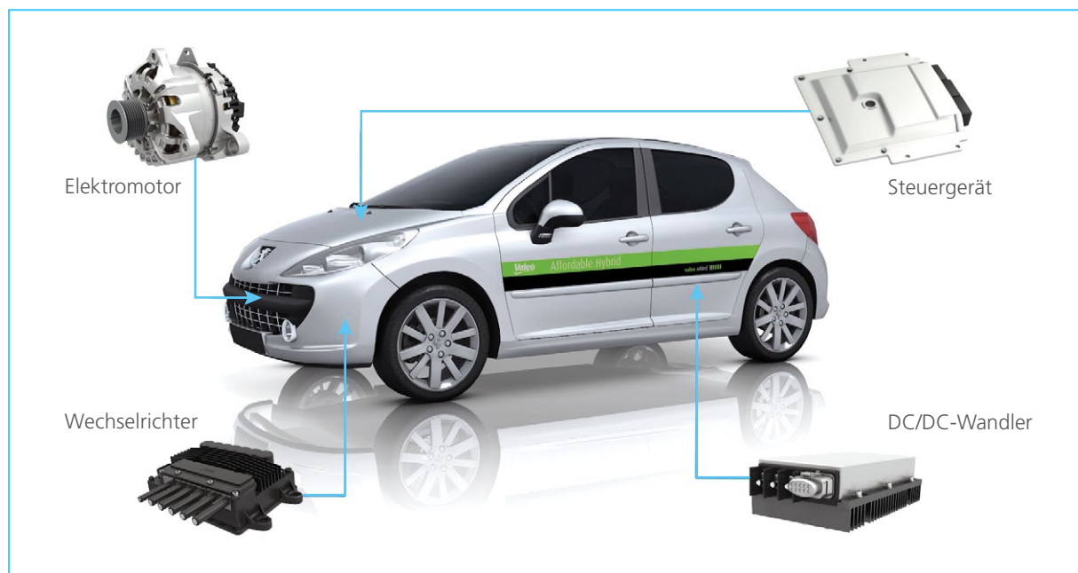
Abbildung 2: Konfiguration eines Hybrid-Demofahrzeugs von VALEO.
