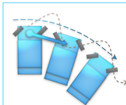
Abbildung 1: Beispiel eines seitlichen Manövers nach rechts: Das Fahrzeug bewegt sich automatisch in einem „indirekten“ Bewegungsmodus, wenn der Joystick in einer konstanten Rechtsposition bleibt.
