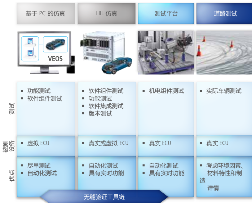
图 1：在多个测试阶段无缝使用 dSPACE 工具链。
