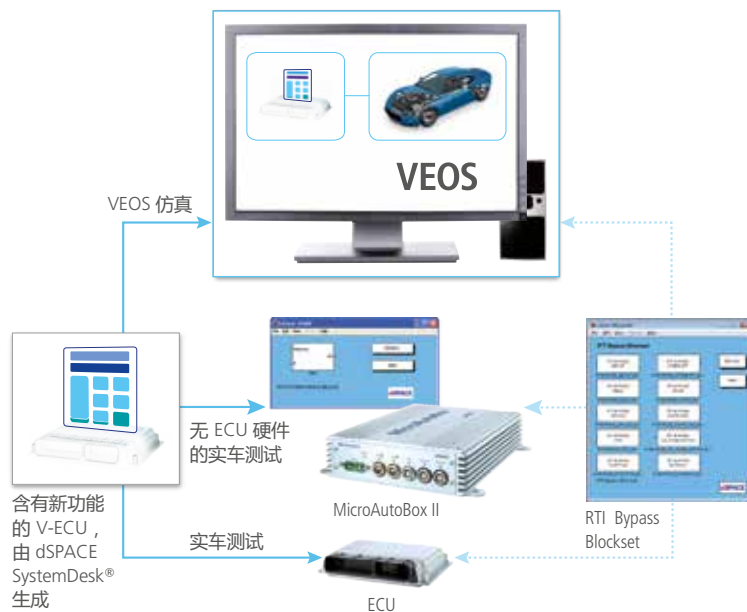
图 1：借助于 RTI Bypass Blockset，新的 ECU 功能可以在不同平台上使用，例如：VEOS、MicroAutoBox II 或 ECU 原型。
