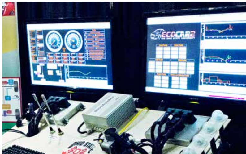
图 2：ControlDesk® Next Generation 既用在 dSPACE HIL 仿真器的测试中，也用在 dSPACE MicroAutoBox II 控制器的应用程序中。
