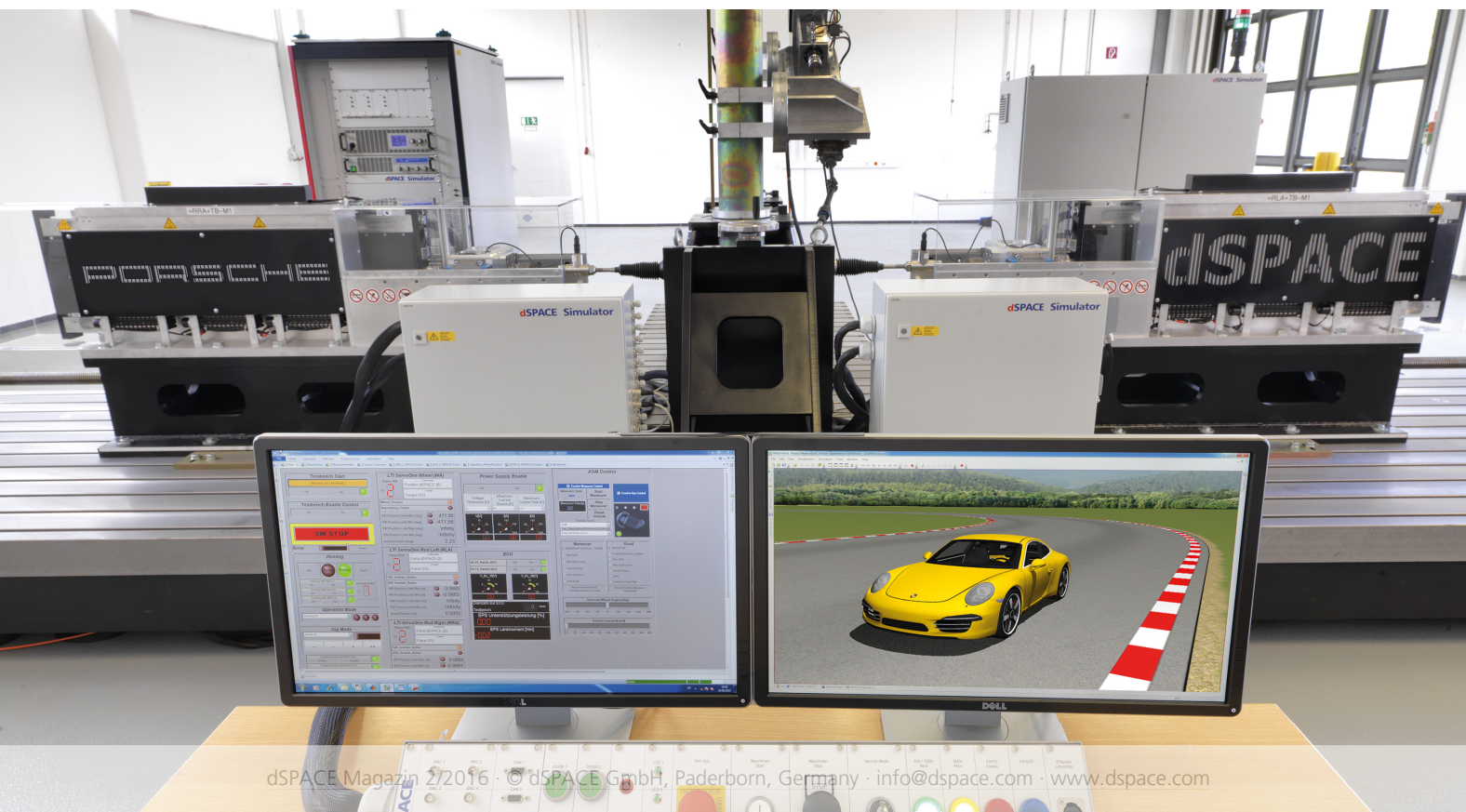
Abbildung 4: Der mechatronische Prüfstand samt Bedienplatz mit ControlDesk zur Steuerung der Tests (links) und MotionDesk zur Visualisierung der Fahrmanöver (rechts).
