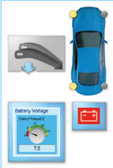
图 1 (左图)：基于信号测试的工作原理：在该示例中，转向信号行为是在载板低电压 (7.5V) 下测试的，并且是在转向信号开关激活之后。
