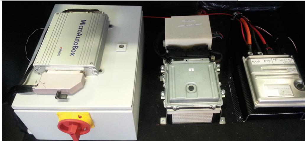
Abbildung 6: Die MicroAutoBox II (links) im Demofahrzeug.
