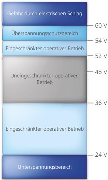
Abbildung 1: Definition der Sicherheitsspannung.
