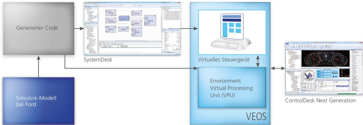
VEOS simuliert den mit SystemDesk erzeugten AUTOSAR-Code mit einem Bottom-up-Prozess. Die Simulationssoftware lässt sich nahtlos mit dem etablierten Mess- und Kalibrierwerkzeug ControlDesk integrieren.
