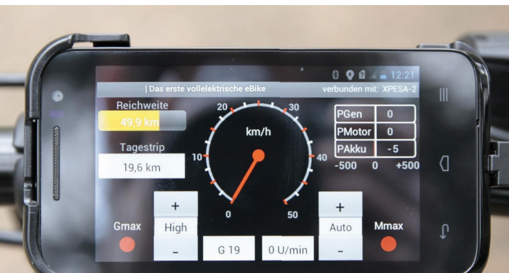
Abbildung 2: Bedienoberfläche des über Bluetooth angekoppelten Smartphones.
