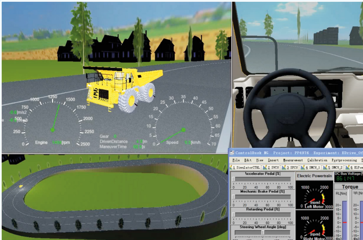
Anschaulich visualisiert: Mit dSPACE MotionDesk können die SANY-Entwickler die auf dem HIL-System simulierte Fahrmanöver und Szenarien in einer anschaulichen 3D-Online-Animation nachstellen und so die Auswirkungen ihrer Parameteränderungen in Echtzeit sichtbar machen.
