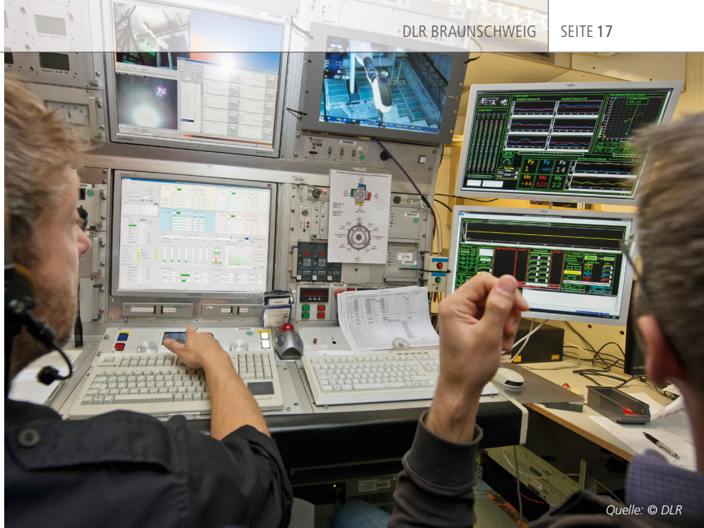
Bedien- und Überwachungssysteme für den Windkanalversuch, mit zwei ControlDesk-Oberflächen rechts im Bild.
