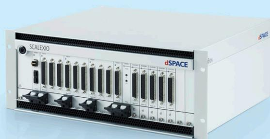
ラックマウントバージョンは 19 インチシステムに搭載可能であり、主にプロジェクト固有の HIL システムで使用します。
