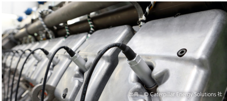
制御対象である多数のシリンダでは、特に効率性の高いシミュレーションモデルを使用して SIL および HIL テストを行う必要がありました。
