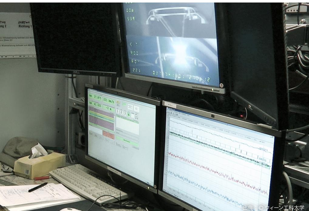
リアルタイムシステムではステートオブザバから受信した計測データに備え、摩擦力などの障害を予測することも必要です。これらすべてのタスクをリアルタイムで完了するため、ウィーン工科大学では新たな数値法だけでなく、極めて強力なリアルタイムプラットフォームが必要となりました。
