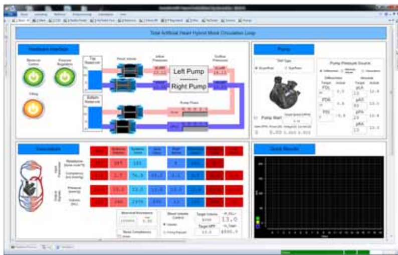
图 3：dSPACE 实验软件 ControlDesk Next Generation 提供了中央用户界面，可以记录数据、更改参数和图形化展示不同的系统状态。
