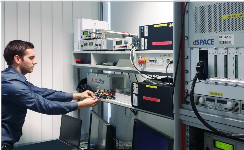
图 2 : 大陆公司位于 Regensburg 的一个 HIL 测试台。
