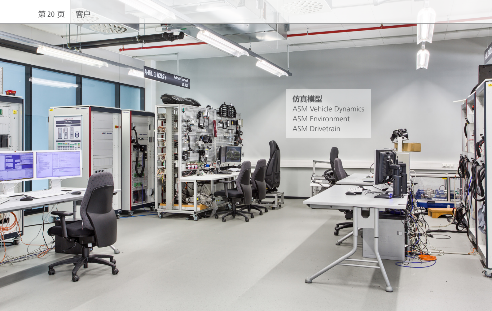
图 1：用于验证传动系统/底盘系统的 HIL 测试台架。中后方有一个装置用于安装 ECU 以及与之集成的真实部件（节流阀、喷油器、变速箱阀门、电子驻车执行机构、散热器百叶窗等）。
