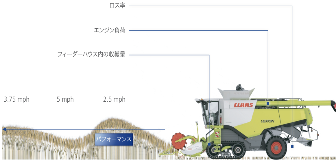
環境要因に即した収穫プロセス、運転操作、および機械パラメータ。
