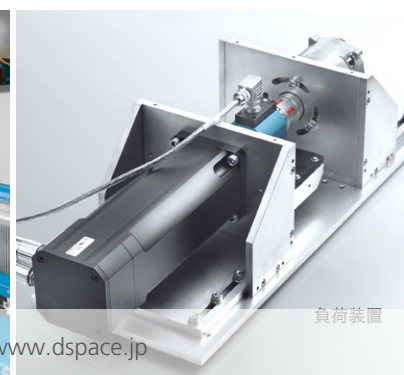
ステアリングシステム用テストベンチ (両側式リニアモーター)
