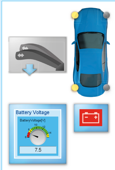
Abbildung 1 (links): In diesem Beispiel wird der Verlauf des Blinkersignals nach Betätigung des Blinkerhebels und bei niedriger Bordspannung (7,5 V) signalbasiert getestet.
