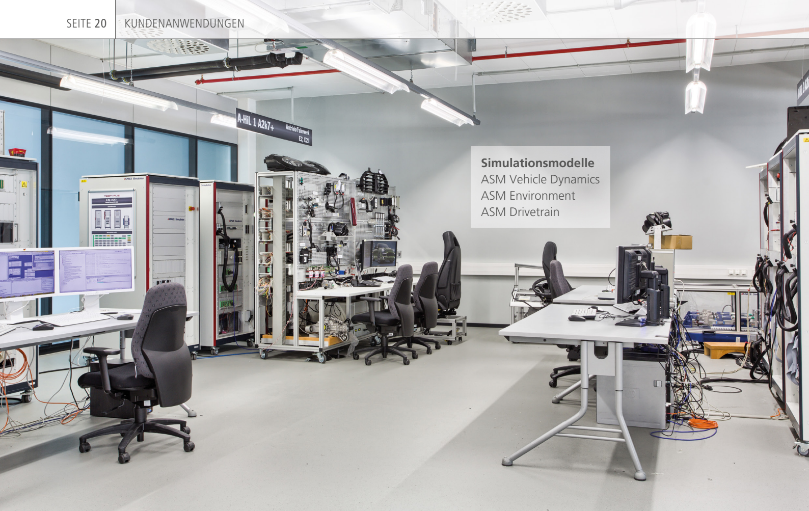
Abbildung 1: HIL-Prüfstände für die Absicherung der Domäne Antrieb/Fahrwerk, in der Mitte hinten ein Aufbau zur Aufnahme der Steuergeräte und für die Integration realer Komponenten (z.B. Drosselklappen, Injektoren, Getriebe-Ventile, Aktoren für die elektrische Parkbremse, Kühlerjalousie, etc.).
