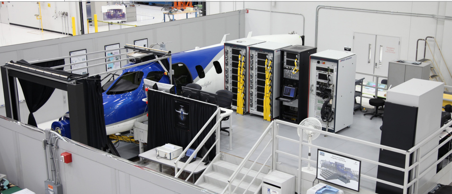
测试实验室包括了铁鸟试验台和三台 dSPACE 的 HIL 仿真设备
